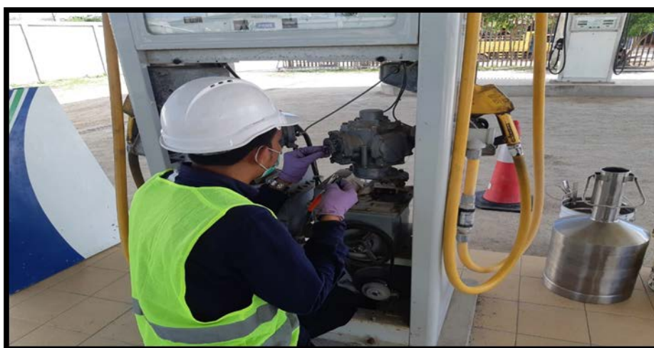
FIGURA 28: ATIVIDADE VERIFIKASAUN NO KALIBRASAUN IHA PAK ALBATROS IHA BAUCAU
